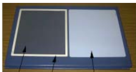
PPSフィルム 枠 トリチウム用IP BAS-TR 20cm X 25cm ワンタッチフィルムとトリチウム用イメージングプレート
